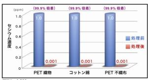
吸着処理温度: 25℃ 吸着処理時間: 24hr
