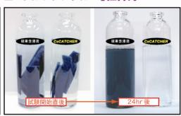
固液比 1:100 におけるセシウム吸着試験 (左=従来含浸法: 右=セシウム吸着繊維材「CsCATCHER」使用)
