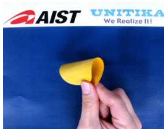
図1. ポリイミド=シリカナノコンポジット多孔体
