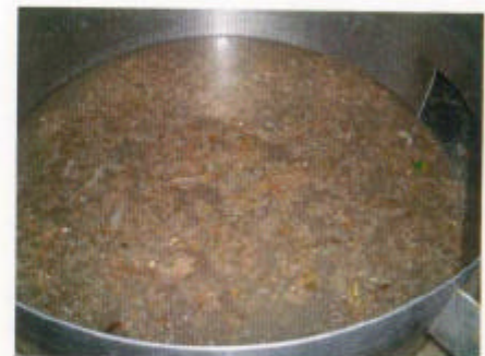
運転後のスワール内部のきょう雑物 きょう雑物除去率 99%以上
