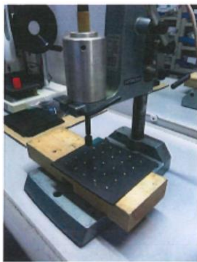
インサートナット圧入写真
