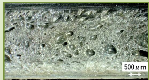
射出発泡成形断面の発泡セルの様子 (上)PA6/セルロースナノファイバー (下)PA6ニートレジ
