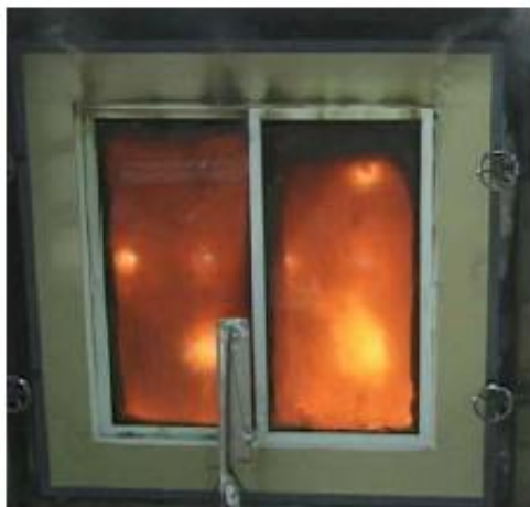
非加熱側の試験体の状況
