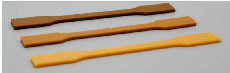
「セルロースナノファイバー含有ナイロン6樹脂」(当社開発品)
