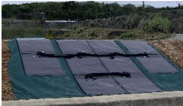
(写真2) 設置完了したフィルム型ペロブスカイト太陽電池
